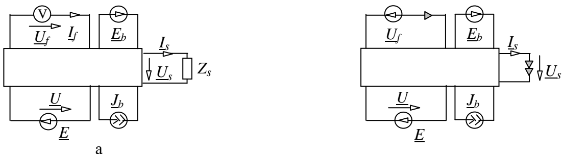
Рис. 3.6.1. ИДС с искомым резистором (а) и ее СКЭ на основе независимых источников (б)
