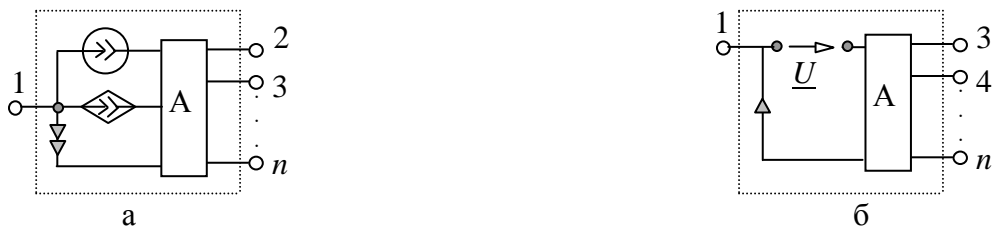
Рис. 3.10.7. Обобщенные схемы n -полюсников, в которых не выполняются первое (а) и второе (б) топологические условия существования Z -параметров
