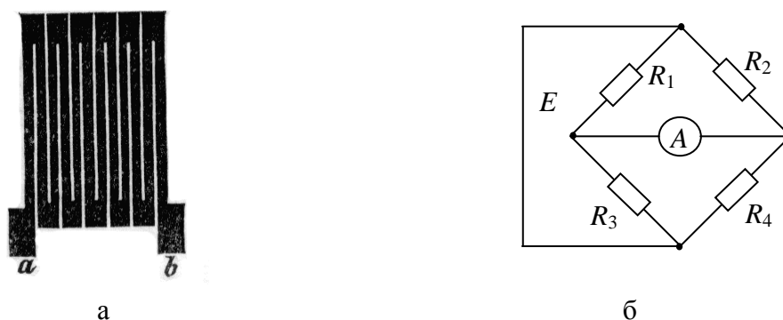
Рис. 1.2. Болометр [ http://ru.wikipedia.org/wiki/Болометр ] и мостик Уитстона [91]
