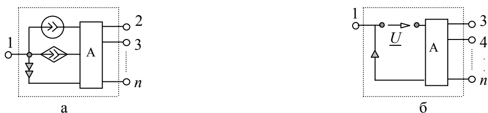
Рис. 3.3.7. Обобщенные схемы n -полюсников, в которых не выполняются первое (а) и второе (б) топологические условия существования Z -параметров
