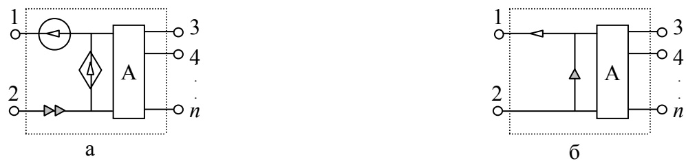
Рис. 3.3.3. Обобщенные схемы n -полюсников, в которых не выполняются первое (а) и второе (б) необходимые топологические условия существования Y -параметров
