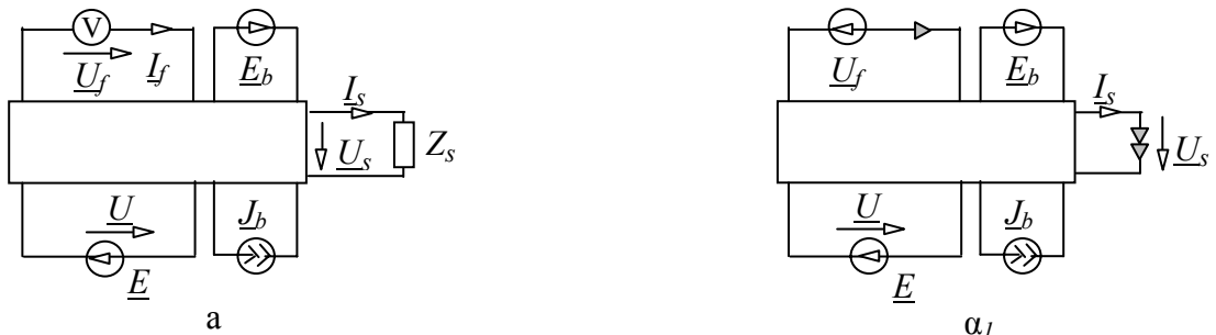
Рис. 4.10.1. ИДС с искомым резистором (а) и ее СКЭ на основе независимых источников (б)
