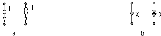
Рис. 1.1.2. Нуллоры: направленный нумерованный (а) и направленный нумерованный взвешенный (б); слева на каждом рисунке нуллатор, справа норатор
